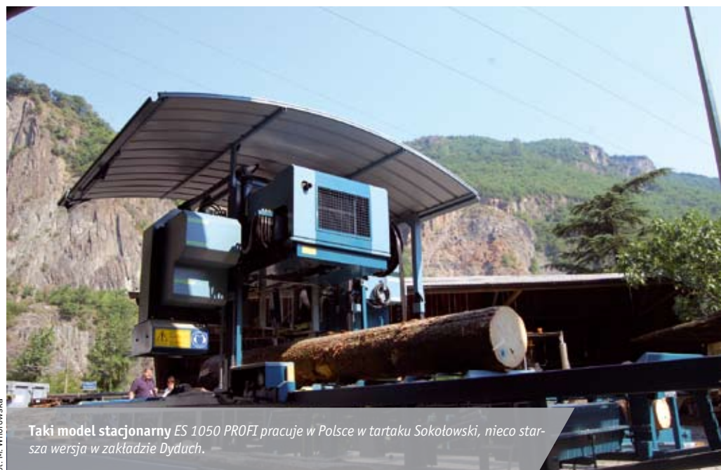
Kłoda leży w miejscu, a support wraz z pilą i kabiną operatora w trakcie przetarcia przemieszcza się nad nią.
