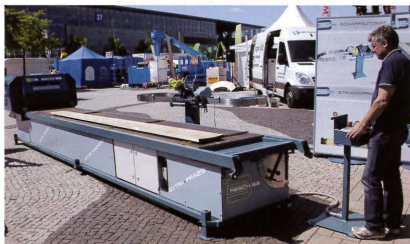
W najnowszym modelu DB 5200-65 urządzenie obrzyna nie jedną, lecz obie strony deski równocześnie, w idealnie równoległej linii.
