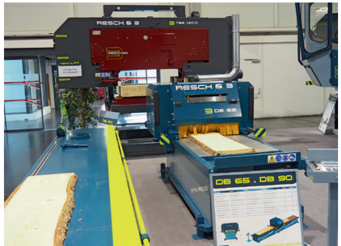
Mit im Gepäck hatte Resch & 3 auch eine Trennbandsäge (Hintergrund) sowie den Doppelbesäumer des Typs DB 65
