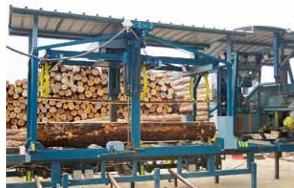
Abgetrennte Schnittware wird mit einem automatischen Greifwagen abgenommen
