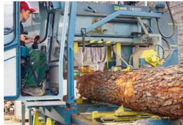
Der Bediener sieht mittels Laserlinie genau, wo die Bandsäge schneiden wird
