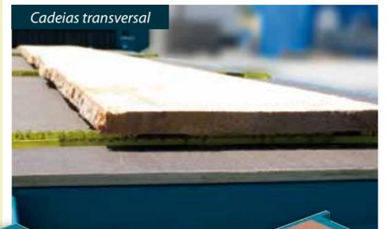
**Muito precisa:** A tabua permanece sobre a mesa e so a cabeça se move para trás e para a frente. Além disso, dois rolos de pressão a frente e atrás das serras e que empura e fixa a placa. Este novo método de trabalho é único no mercado e garante um corte exato paralelo, em linha reta.
