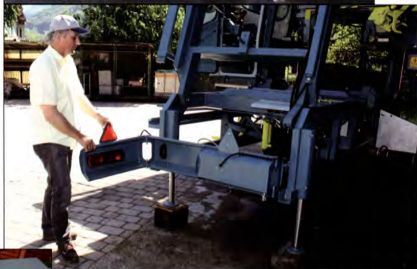
Les rallonges sont montées sur vérins pour gagner du temps lors de l'installation. La plaque minéralogique et les feux sont escamotables durant le chantier et sont protégés.
