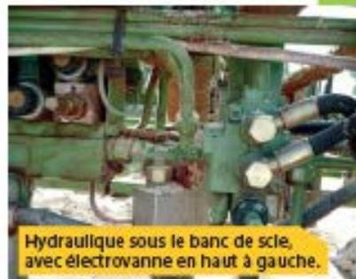
Hydraulique sous le banc de scie, avec électrovanne en haut à gauche.
