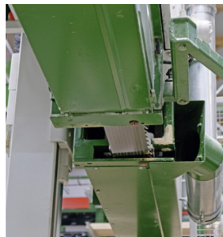
Die TBS 1200 von Resch & 3 trennt bis zu 1050 mal 300 mm starke BSH-Elemente auf
