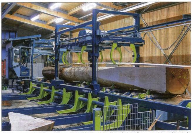
"Ein-Mann-Sägewerk". Mehrere Stämme werden auf die Rundholzauflage aufgelegt. Alles weitere wird vom Mann in der (mitfahrenden) Kabine gesteuert. Jeder einzelne Stamm wird aufgeladen, eingeschnitten und die Schnittware mittels Greiferwagen in Längsrichtung automatisch in (bei Meßmer) fünf verschiedene Boxen einsortiert. Foto: Resch & 3
