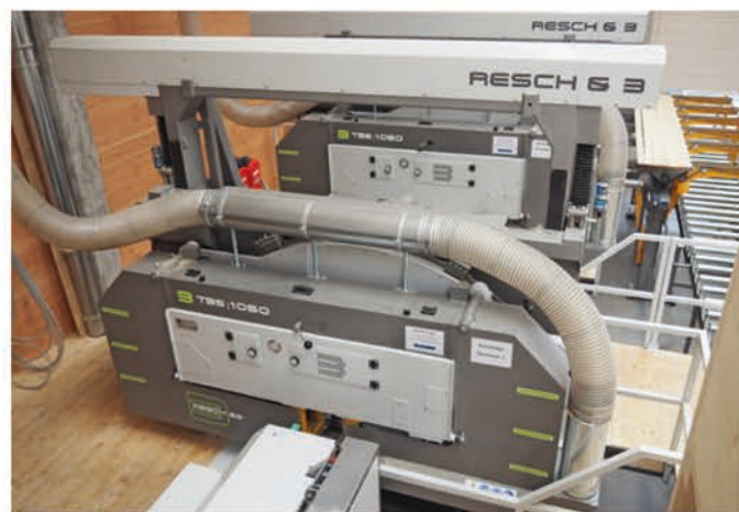
August Brühwiler entschied sich für zwei baugleiche Trennbandsägen des Typs TBS 1050 von Resch & 3
