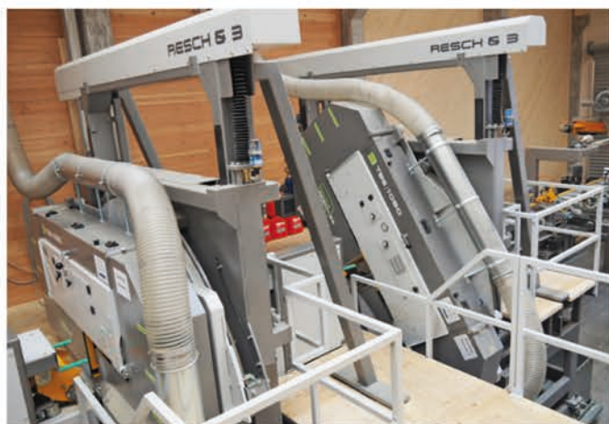
Die Besonderheit: Beide Trennbandsägen sind von 0 bis 90° stufenlos neigbar – das sorgt für hohe Flexibilität in der Produktion
