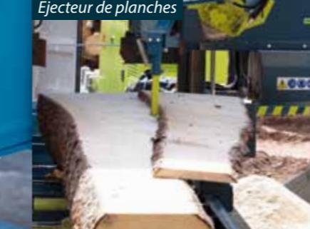
**Guide lame à pression:** Les guides à pression hydrauliques assurent un meilleur guidage de la lame de scie et une précision encore accrue. La précision de coupe est ainsi maintenue même à des vitesses très élevées. Les deux guides peuvent être ajustés individuellement au plus près du tronc.
