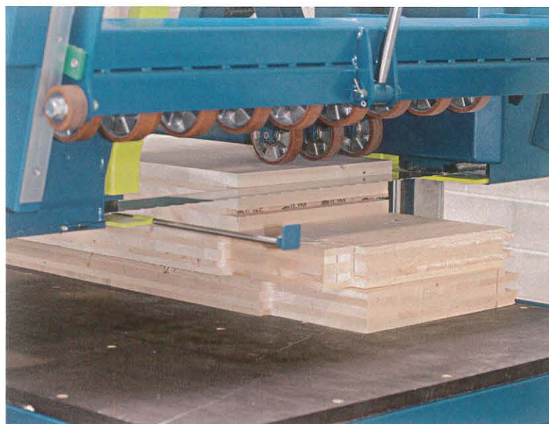
Druckrollen sorgen dafür, dass die aufgetrennten Lamellen nicht verrutschen.
