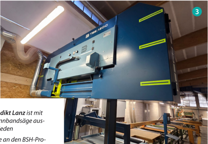
3 Aufgrund der beengten Platzverhältnisse fährt die Säge in eine hohe Parkposition, sodass man problemlos darunter durchgehen kann
