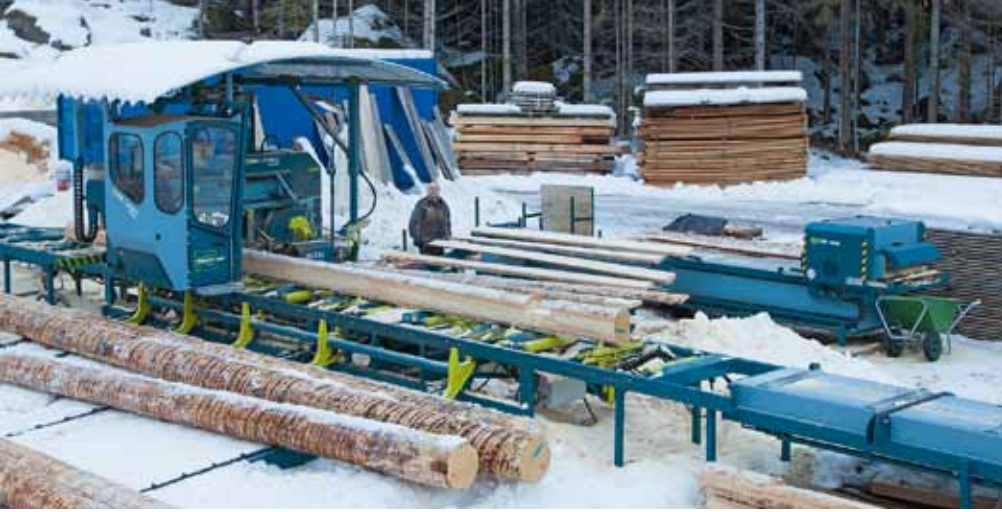
Die stationäre Blockbandsäge ES 1050 Profi bei Joachim Steiner in Südtirol
