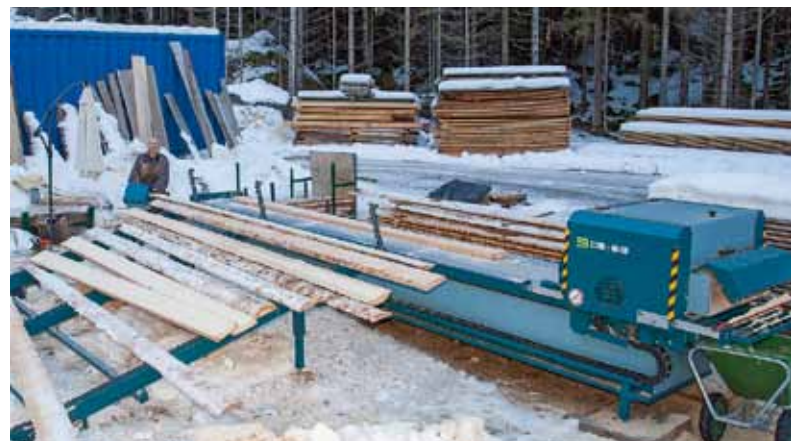
Für den letzten „Schliff“ wurde bei Joachim Steiner noch der Doppelbesäumer DB65 von Resch & 3 installiert
