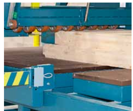
Präzise trifft das Sägeblatt auf die Leimfuge
