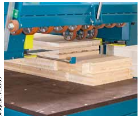
Druckrollen fixieren die aufgetrennten Lamellen
