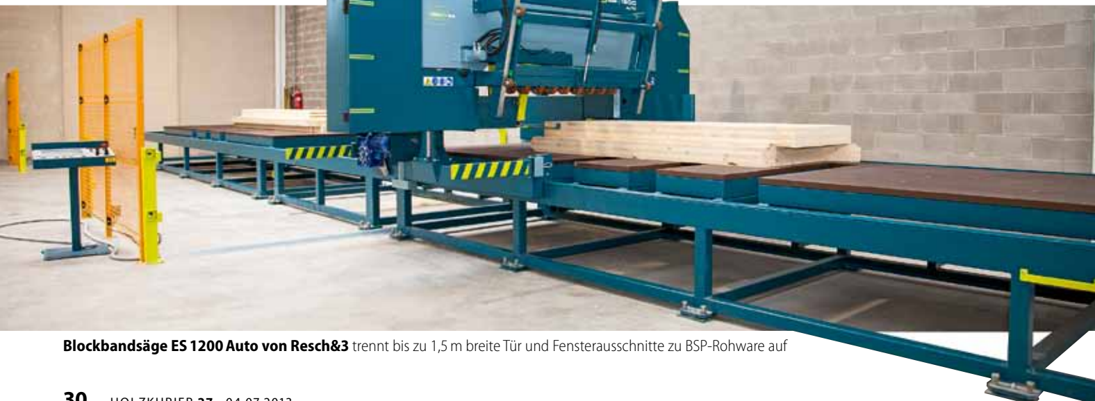
Druckrollen fixieren die aufgetrennten Lamellen
