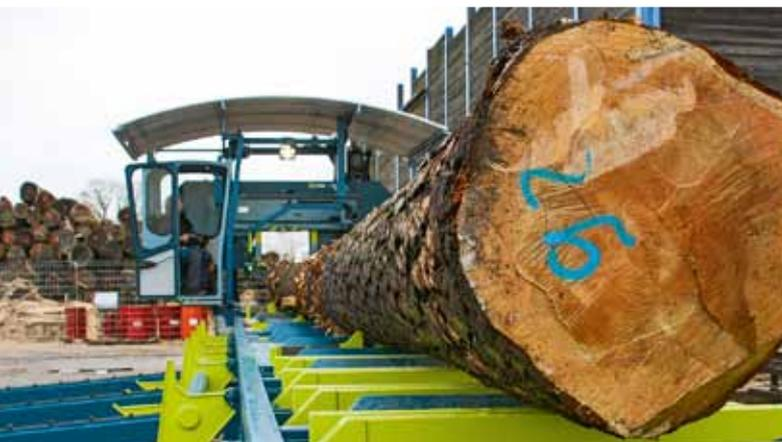
**Ein Starkholzbloch** liegt zum Verarbeiten bereit – die Resch & 3-Bandsäge bei Robeta Holz bewältigt bis zu 1,5 m starkes und 14 m langes Rohholz
