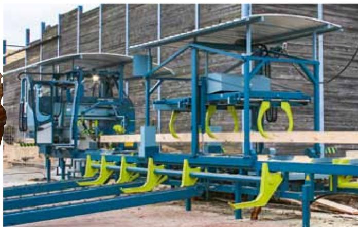
**Der Greifwagen** packt die Schnittware und legt sie vollautomatisch in die gewünschte Sortierbox
