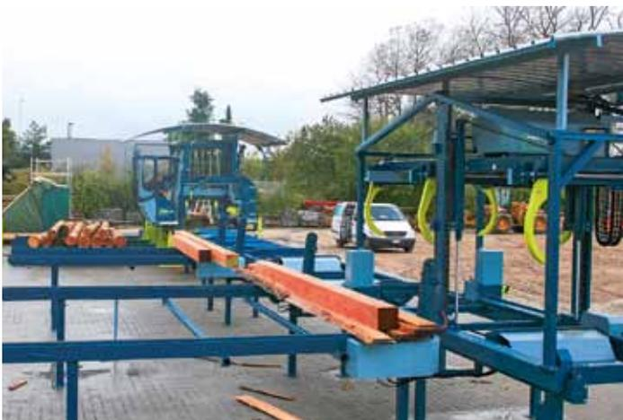
**Dänischer Spezialfall:** 1,4 m starke Eichenstämme, die bis zu 11 m lang sein können, werden zu Bohlen aufgetrennt und mit Greifwagen sortiert
