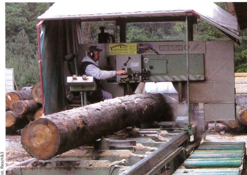
Do obsługi traka potrzebny jest jeden operator, który za pomocą przycisków steruje maszyną.
