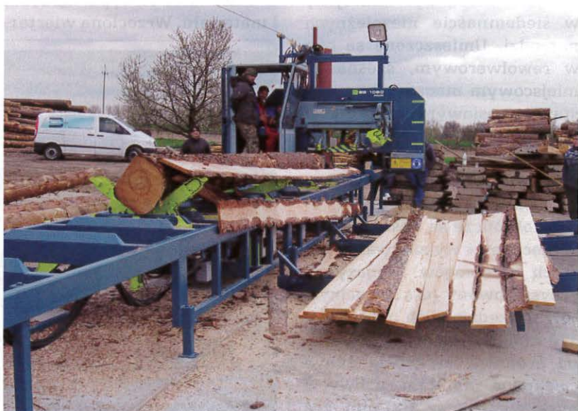
Trak jest wyposażony w kapówkę, dzięki której deski można przycinać automatycznie na żadaną długość. fot. Resch & 3
