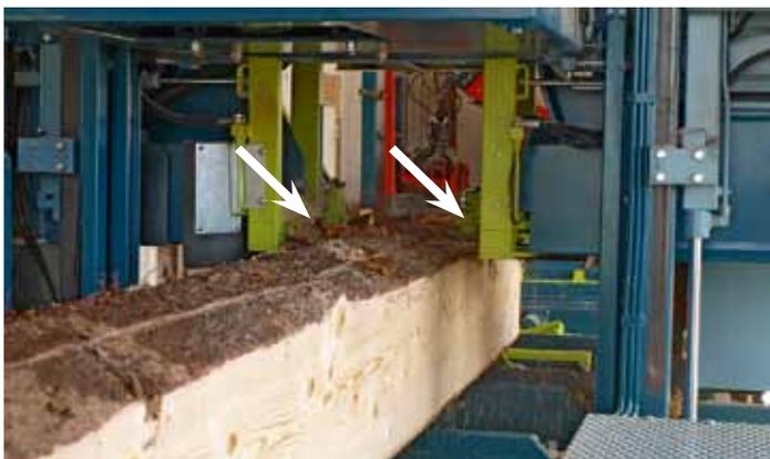
Zwei Vorschneider (Pfeile) entfernen die Rinde unmittelbar, bevor das Sägeblatt ins Holz greift
