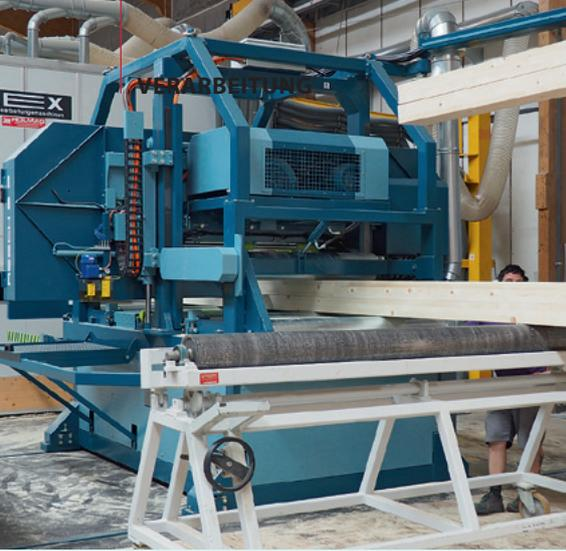
Die Trennbandsäge TBS 1200 von Resch & 3 steht nach dem Rex-Hobel
