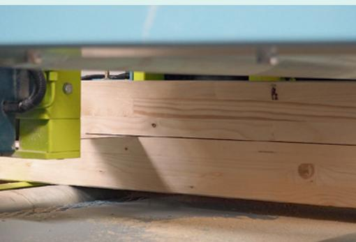
Das Sägeblatt hinterlässt eine 2,1 bis 2,2 mm starke Schnittfuge
