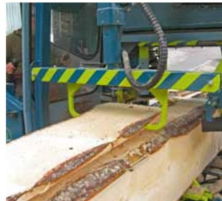
**Das mit dem Querschneider** abgekappte Brett kann mit der Abnehmerzange während der Rückfahrt einzeln abgelegt werden
