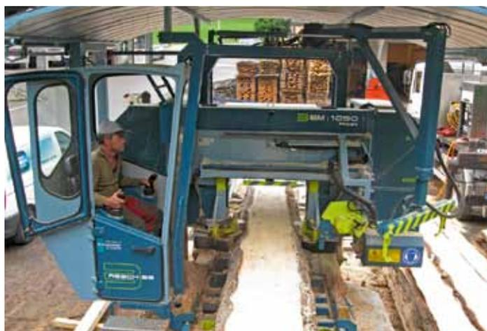
**Von der mitfahrenden Kabine aus** hat Toni Braunwalder die Vorschneider, Querschneider, Brettabnehmer und Sägeblattdruckführung im Überblick
