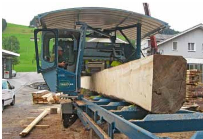
**Rasch einsatzbereit:** Die EM 1050 Profi von Resch & 3 ist mit einem Fahrwerk ausgestattet, das eine Geschwindigkeit bis zu 80 km/h erlaubt
