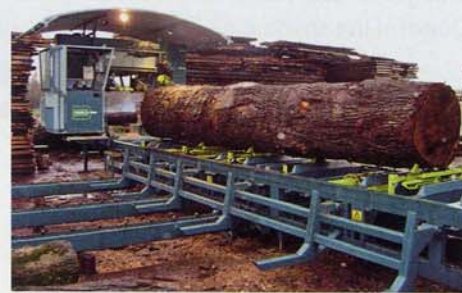
Probe auf's Exempel: 1,2 m im Durchmesser und 8,5 m lang wurde Eichenstamm aufgetrennt
