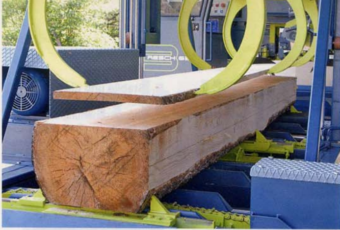
Automatischer Greiferwagen legt jedes Brett nach Schnitt am Ende der Gleisanlage ab
