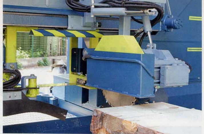
Trennschnitt mit Kreissäge während des Schnittes mit der Bandsäge FOTOS: RESCH & 3
