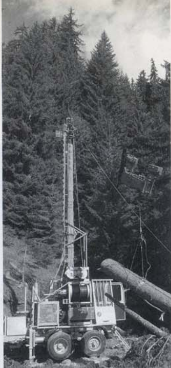
Mobile Kippmast-Seilkrananlage MS 800 UNI mit Zielautomatik
