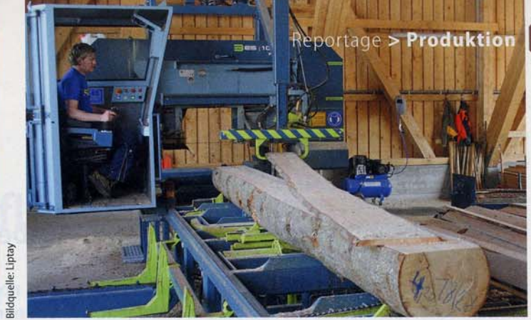
Der automatische Brettabnehmer erspart Pletzenauer das Verlassen der Kabine und gewährleistet die Qualitätskontrolle jedes einzelnen Brettes
