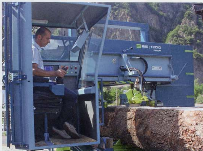
Aus der mitfahrenden Kabine hat Christoph Lunger Säge und Holz im Blick – ständige Qualitätskontrolle ist gewährleistet
