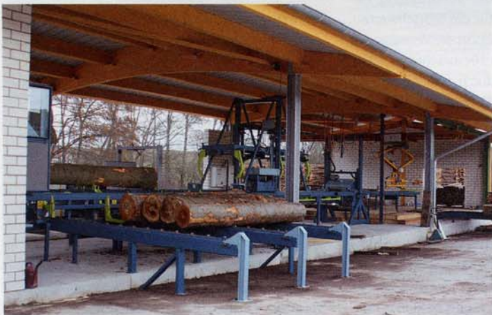
25 m lang ist die neue Blockbandsägen-Anlage bei Mai + Sohn vom Rundholzeinzug bis zur Bürstenmaschine
