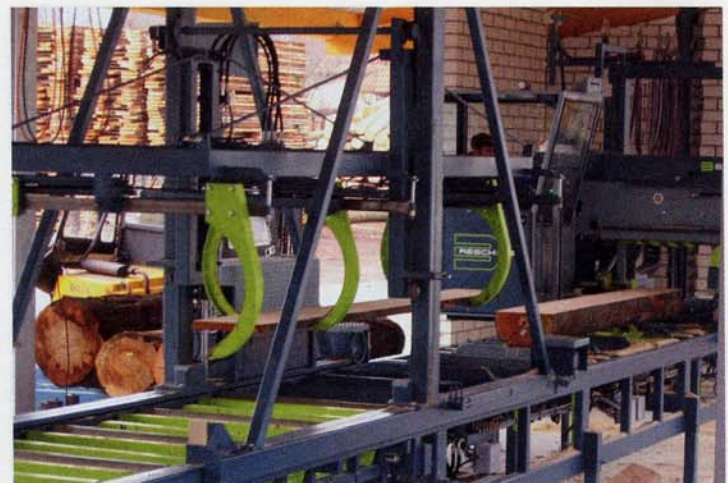
Schonend im Griff: Nach dem Schnitt wird die Brettware automatisch von Greifern genommen und abgelegt
