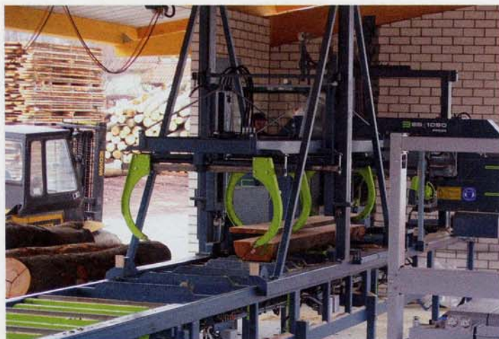
Blockbandsäge ES 1050 Profi von Resch & 3 bewältigt Rundholzdurchmesser bis 1,1 m
